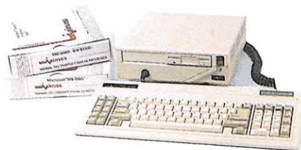
CPU con una unidad de diskette 3 1/2" (720 Kb). Con teclado y sistema operativo MS-DOS 3.2 y GW BASIC 3.2.
